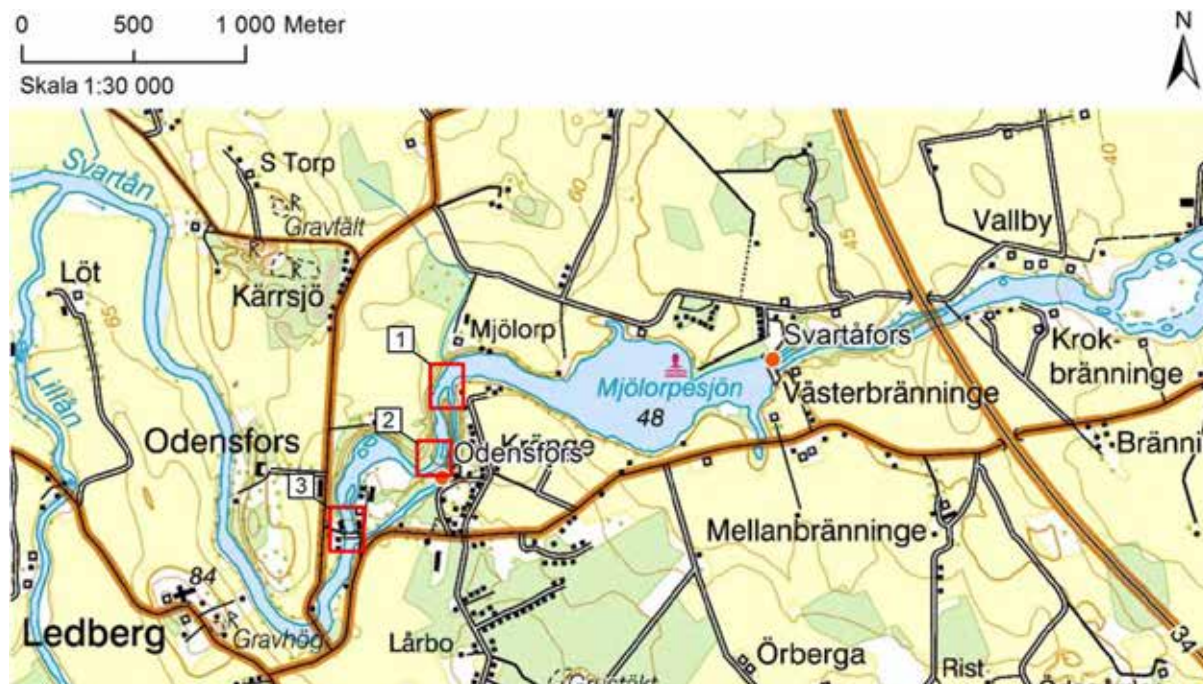
Figur 1. Översiktsskarta för Odensfors kraftstation med delområden 1) Nedre spillfåra, 2) Kraftverk och 3) Dam. ©Lantmäteriet S2014-02-27_02, ©Sweco 2014-07-02.
